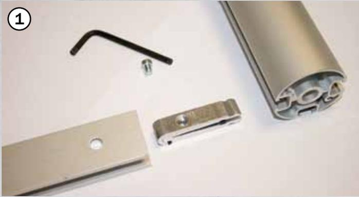
Sie benötigen: ein Standrohr, einen Querträger mit Spanner, eine Schraube und einen Inbusschlüssel.
